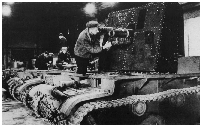
Изготовление самоходных установок 76-мм полковых пушек на шасси Т-26. Ленинград, завод имени Кирова, август 1941 года (АСКМ)
