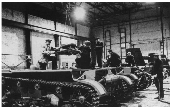
Изготовление самоходных установок 76-мм полковых пушек на шасси Т-26. Ленинград, завод имени Кирова, август 1941 года (АСКМ)
