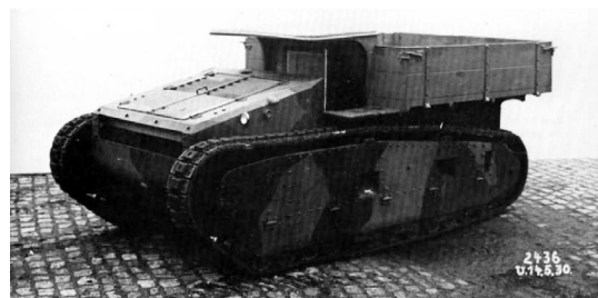
Гусеничный тягач-транспортёр (Rheinmetall), ходовая часть которого была использована для танка, 1930 год
