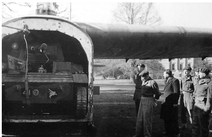
Танк «Тетрарх» в грузовом отсеке тяжёлого планера «Хэмилкар». Тренировочные полёты перед высадкой на материк, 1944 год.
