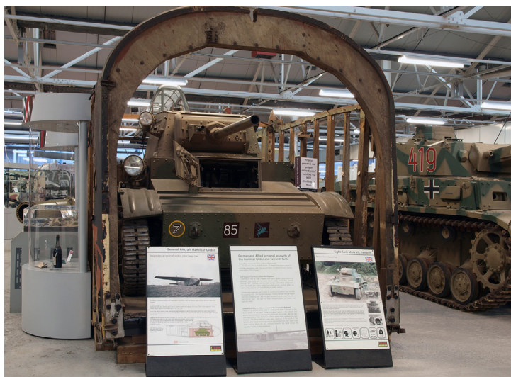
Английский лёгкий танк Mark VII Tetrarch внутри каркаса грузового отсека планера G.A.L. 49 Hamilcar. Танковый музей Бовингтон.
